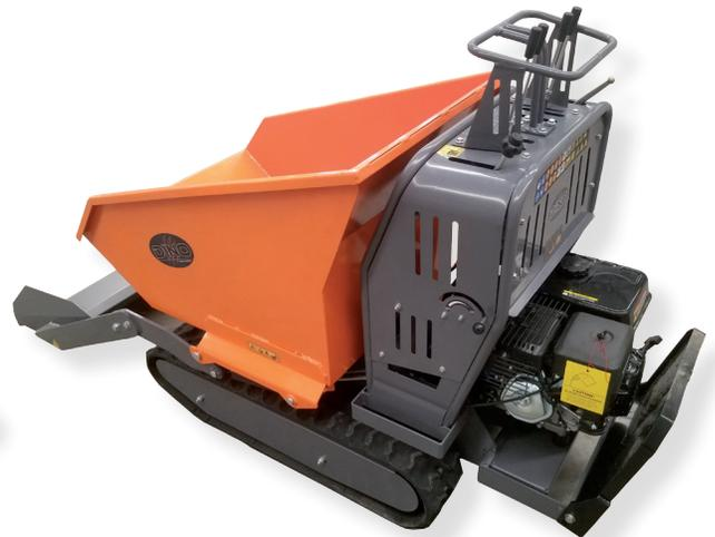
**DD500-05** ist ein neuer Raupendumper mit stufenlosem Hydrostatantrieb und hydraulisch entleerbarer Mulde für bis zu 500 kg Tragkraft. Als besonderes Ausstattungsmerkmal ist hierbei die Frontschaufel zu nennen, die das Beladen mit Sand, Kies etc. vereinfacht. Die rückwärtig montierte und klappbare Standfläche erleichtert
