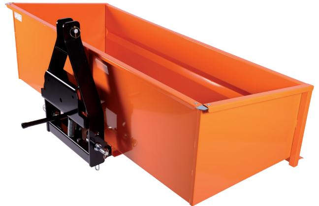
**ELLB150** Die Transportbox ist die ideale Lösung für die Verladung und Beförderung von Schüttgut, Brennholz und sonstigen Materialien. Die Box wird mithilfe der hinteren Dreipunktaufnahme Kat. 0/1 oder mittels Frontkuppeldreieck (optional) des Traktors gehoben. Die Kippfunktion wird manuell mit einem Arretierungshebel ausgelöst, dabei sichert eine stabile Kette den Kippwinkel.
