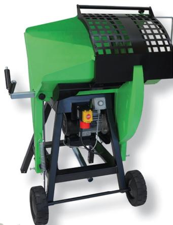
Die Wippkreissägen der Serie „PRO LINE W600“ verfügen über stabile, pulverbeschichtete Stahlrahmen mit soliden Transporträdern. Der Fixierungsbügel und der Schnellentspanner des Keilriemenantriebes erfüllen höchste Sicherheitsanforderungen. Die großen Vorteile der Antriebsübersetzung durch Keilriemen sind eine um ca. 50% erhöhte Messerdrehzahl (2150 U/min.), eine deutlich höhere Schnitttiefe (28 cm beim 600er Sägeblatt) und eine erhebliche Entlastung der Motoreinheit.
